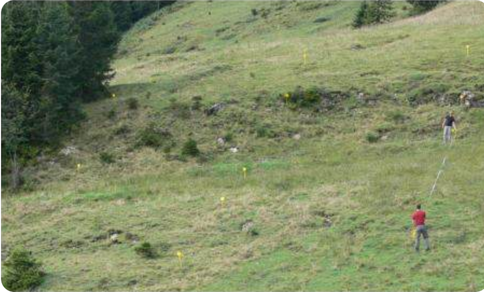
Рис. 5. Формування умовних ліній на території обстеження (ліворуч) та відбір зразків ґрунту у визначених точках (праворуч).
