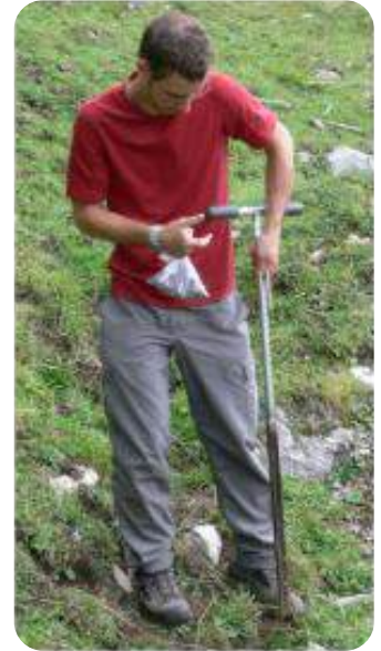
Рис. 5. Формування умовних ліній на території обстеження (ліворуч) та відбір зразків ґрунту у визначених точках (праворуч).
